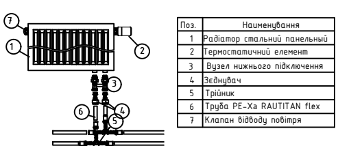
ВУЗЕЛ 1 РАДІАТОР З НИЖНІМ ПІДКЛЮЧЕННЯМ
