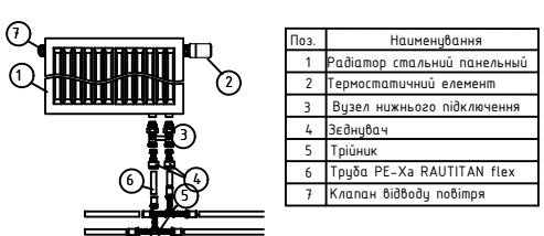
ВУЗЕЛ 1 РАДІАТОР З НИЖНІМ ПІДКЛЮЧЕННЯМ
